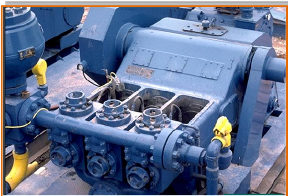
Fig. II.2 : La pompe à boue
