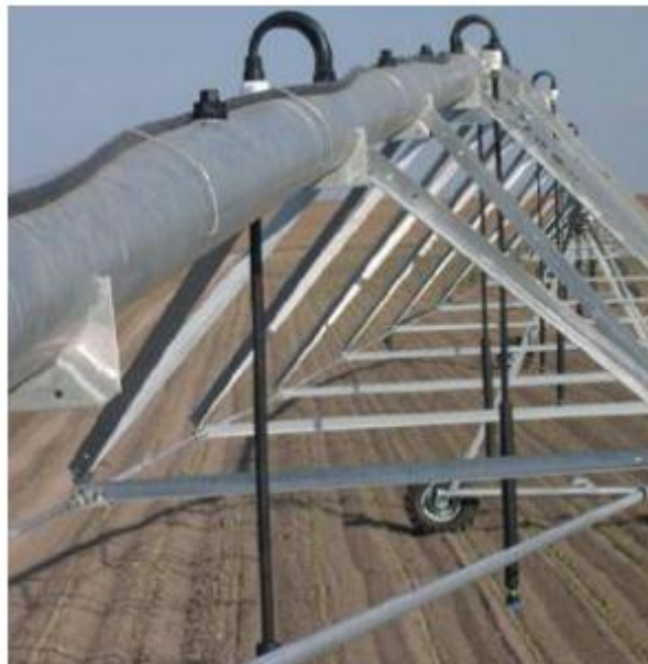
Fig.IV.5 : Travée de pivot d'irrigation [17].
