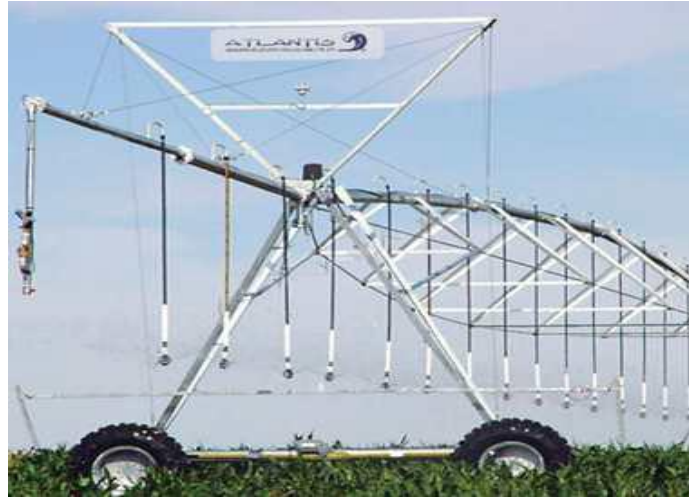
Fig. I.9 : Porte-à-faux de rampe d'irrigation. Photo ATLANTIS.
