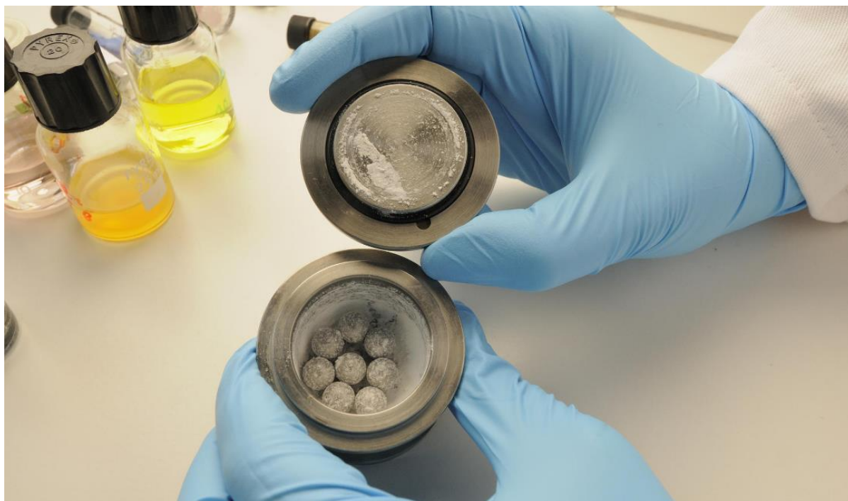
Figure 9 : Mécanosynthèse de borane, matériau utilisé pour le stockage de l'hydrogène. Dans le broyeur, on distingue les billes en acier servant au procédé.
