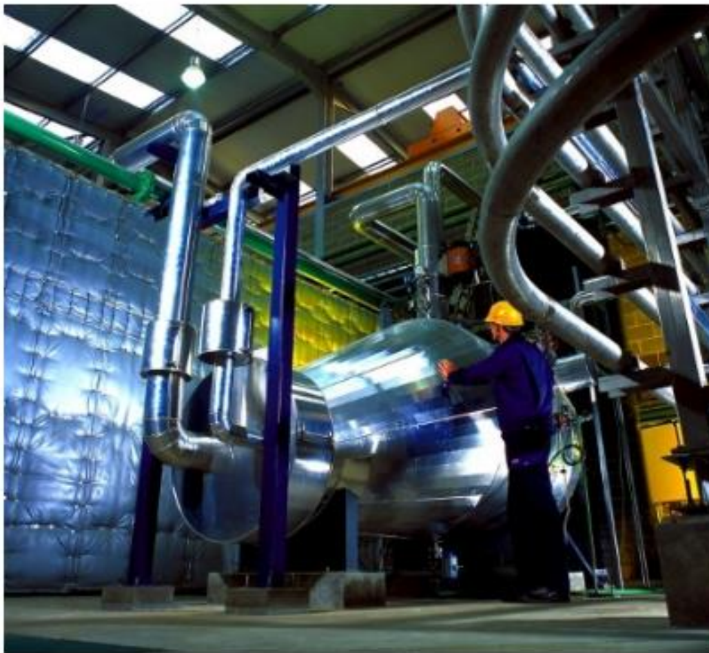
Figure 8 : Cuve d'oxydation par l'eau supercritique (figure par Johnson Matthey)
