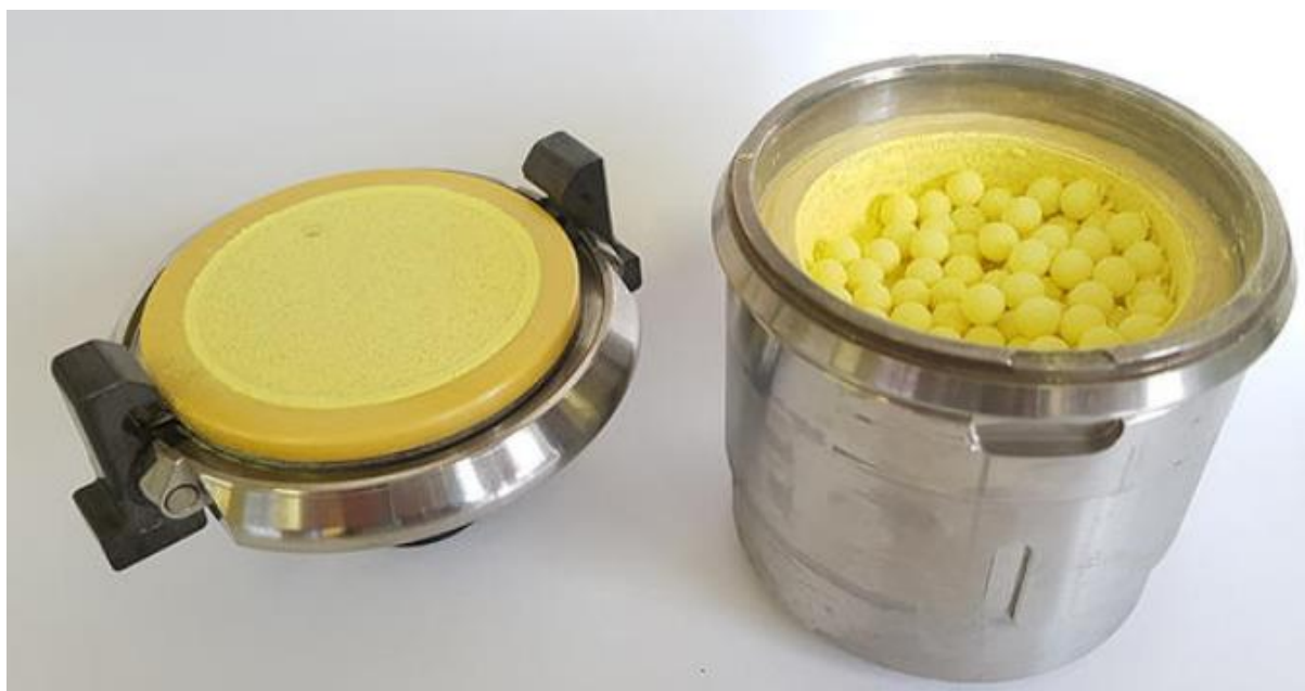
Figure 10 : Mécanosynthèse d'un composé organométallique.
