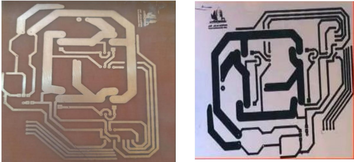
Figure III. 7: Schéma de circuit imprimé de la partie puissance avec ARES
