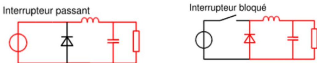
Figure (II.6): Les deux configurations d'un convertisseur Buck suivant l'état de l'interrupteur.
