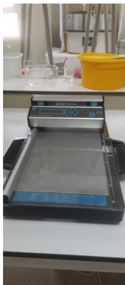
الوثيقة 11 : جهاز قياس مساحة الورقة (CI-202 Portable)
