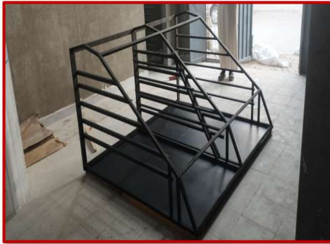
الشكل (III-13): تثبيت الهيكل على القاعدة.
