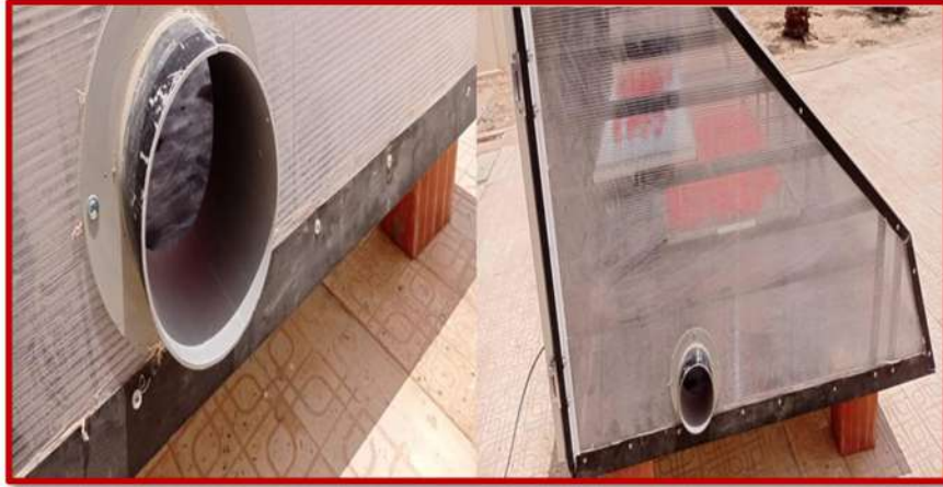
الشكل (III-10): فتحة إدخال الهواء.
