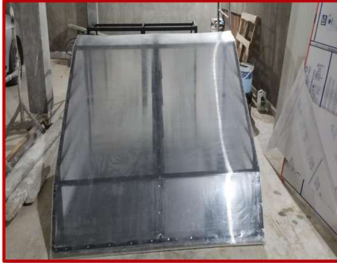
الشكل (III-14): إحاطة الهيكل بمادة البولي كربونات.
