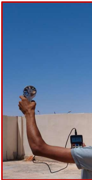
الشكل (10-IV): قياس سرعة الرياح.
