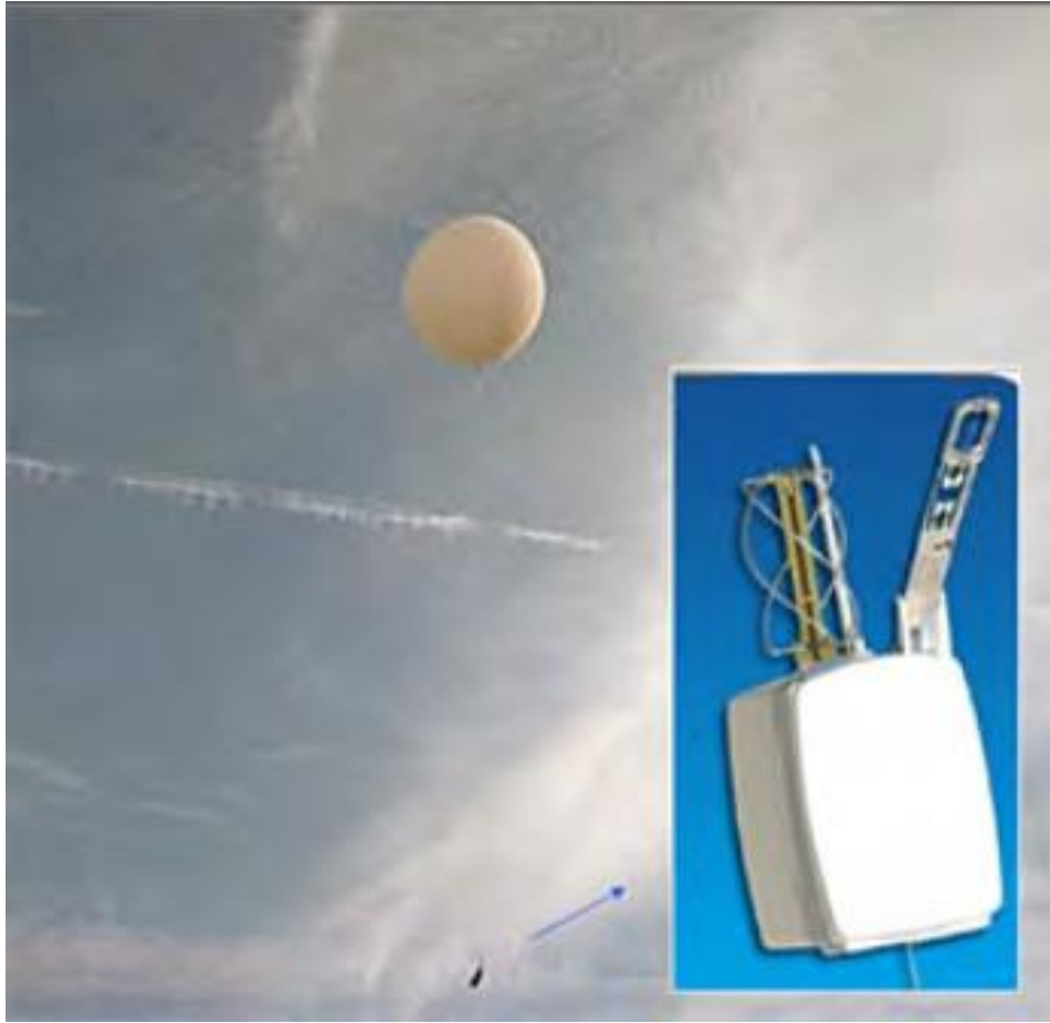
الشكل (3.2): مثال على نظام الراديو سوند ومنطاد الإطلاق (Vaisala RS92).
