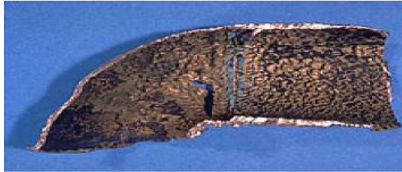
Figure I. 7: Corrosion érosion d'un tube en cuivre véhiculant de l'eau [7].
