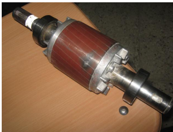
Figure III.8. Le rotor du moteur avec 2 barres cassées.
