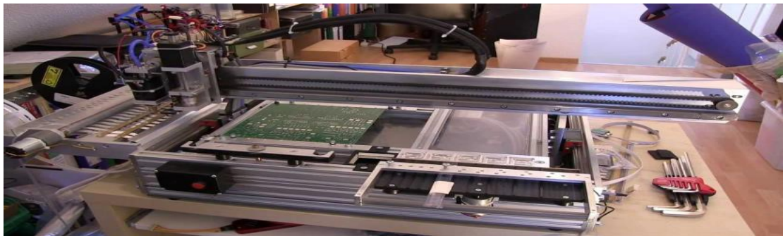
الشكل 17 : آلات الانتقاء والوضع باستخدام الحاسب الآلي
