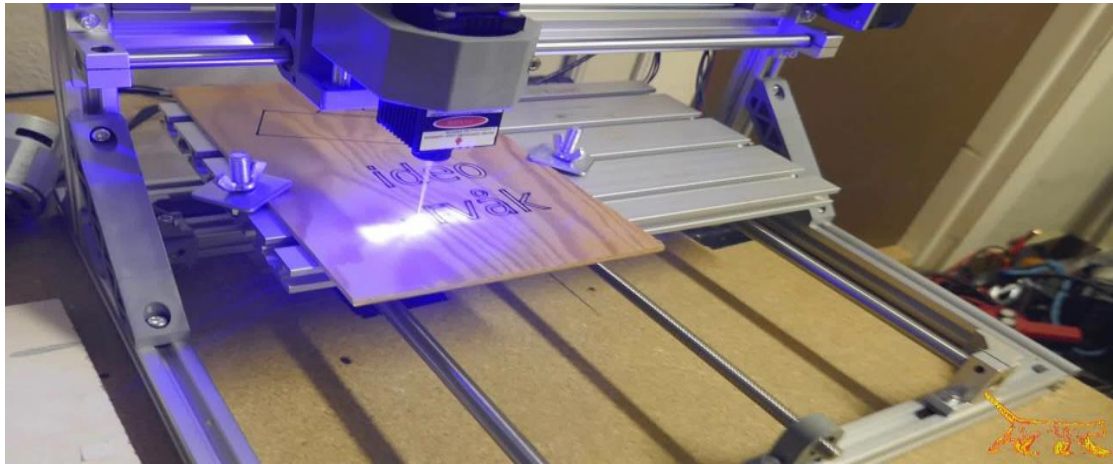
الشكل 15 : ماكينة نقش CNC 3018 5500 ميجاوات ليزر
