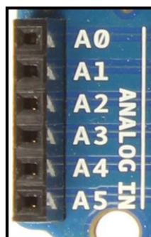
Figure II.12. Les entrées analogiques
