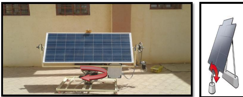
Figure. III.24. Orientation à un axe
