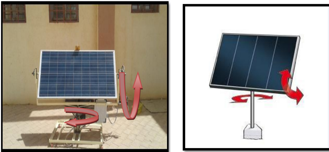
Figure III.25. Orientation à deux axes
