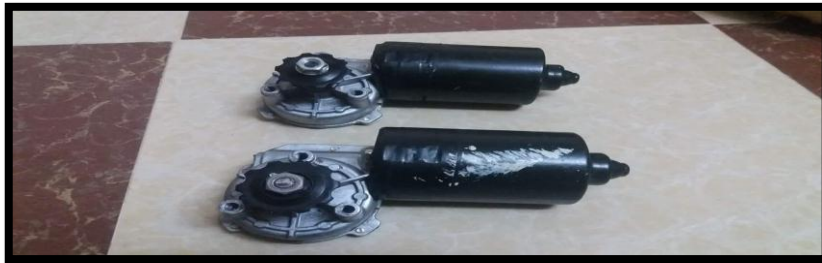
Figure III.11. Moteur à courant continu utilisé dans notre projet
