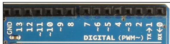
Figure II.11. Les entrées/sorties numériques
