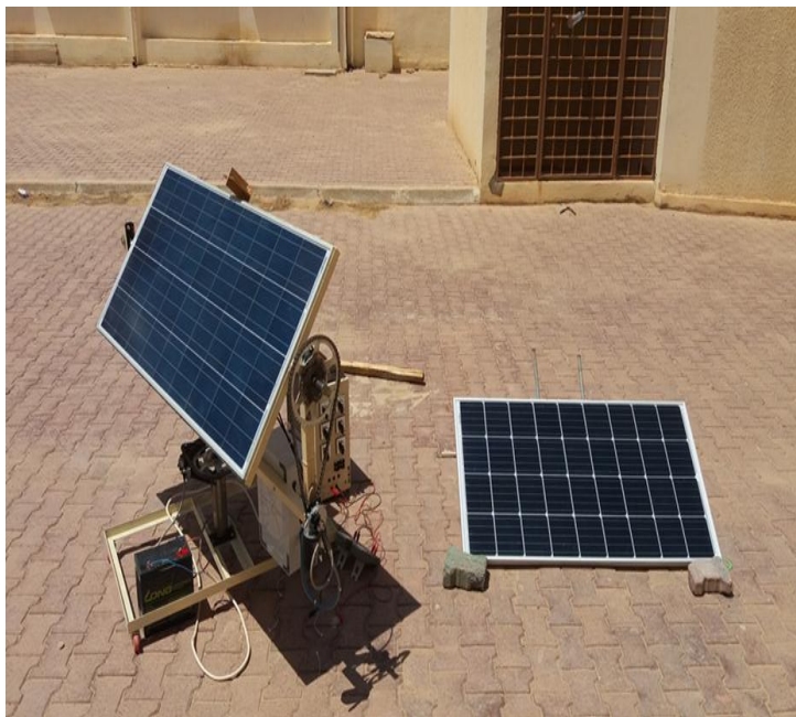
Figure IV.2. Les deux systèmes photovoltaïques, sans et avec suiveur, avec leur plaque signalétique
