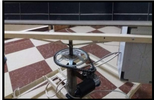
Figure III.28. Moteur 2 qui contrôle l'axe vertical
