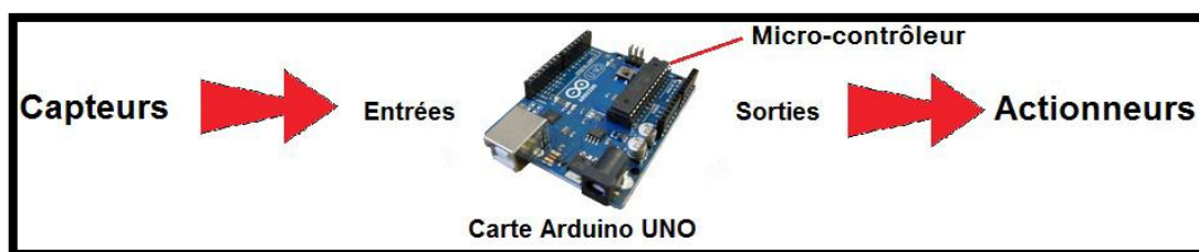
Figure II.1 présentation (capteurs +actionneurs) de la carte Arduino
