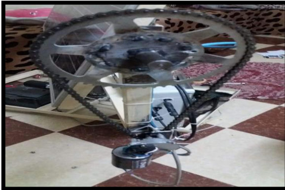
Figure III.27. Moteur 1 qui contrôle l'axe horizontal
