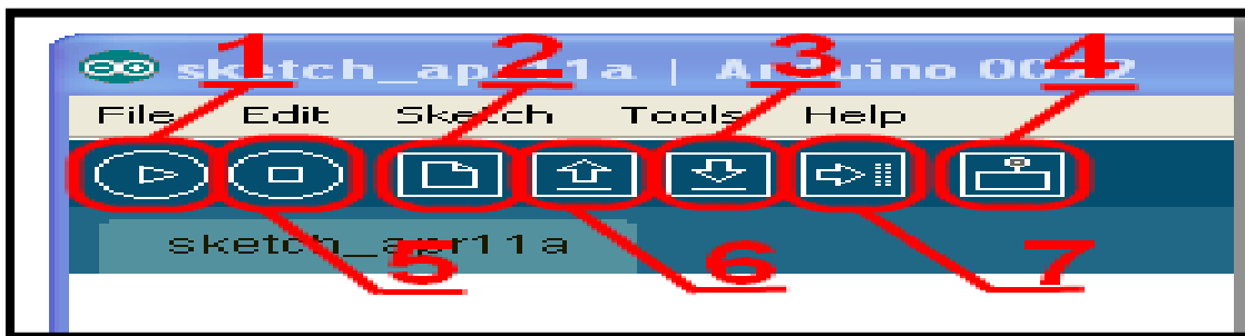
Figure II.4. Les Boutons de programmation de la carte
