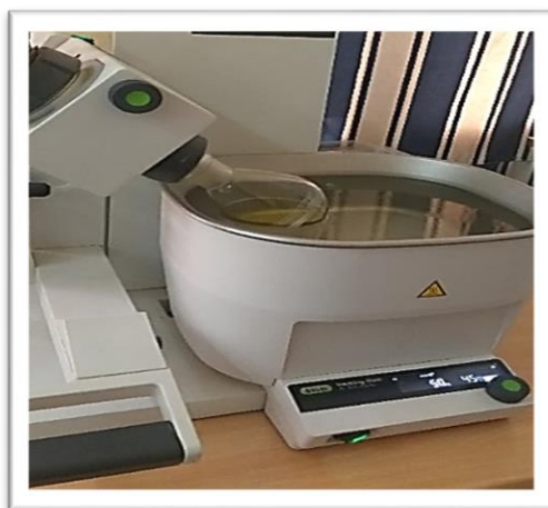
Figure 12 : Montage d'évaporation a pression réduit
