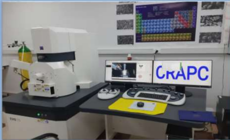
الشكل (12-2): مجهر Zeiss Evo 15 المستعمل للحصول على صور البنية المجهرية للعينات.
