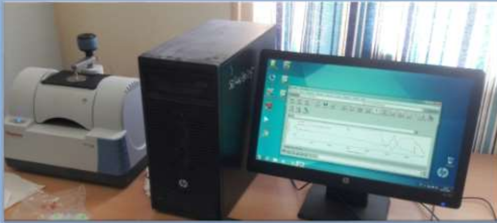
الشكل (2-4): مطياف الأشعة تحت الحمراء المستعمل و لواحقه.
