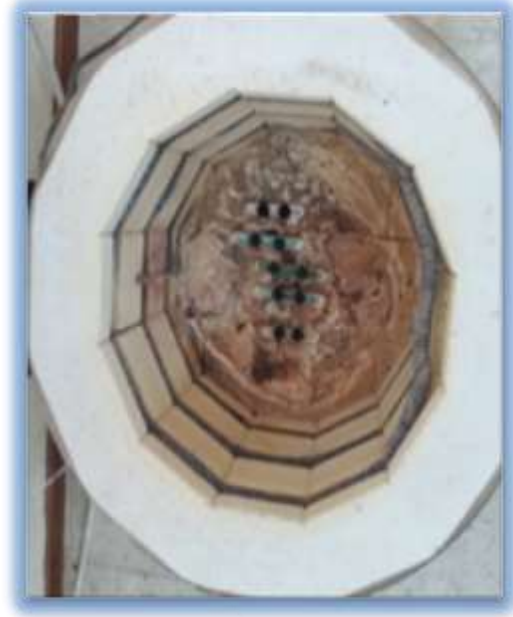
الشكل (3-12): الأقراص في الفرن لعملية التلييد.
