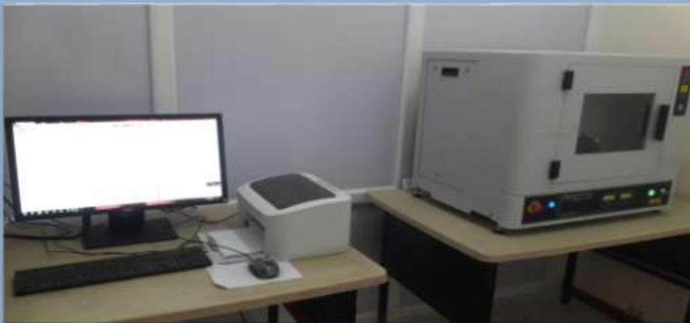
الشكل (9-2): جهاز PROTO المستعمل في تقنية حيود الأشعة السينية.
