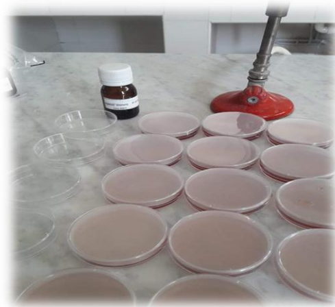
Figure 8: préparation de gélose Slanetz et Bartley. ( AMMARI S, 2019).
