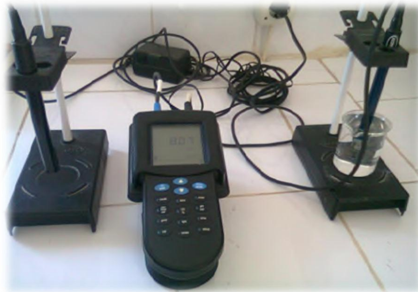
Figure 3: conductivimètre ( AMMARI S, 2019)
