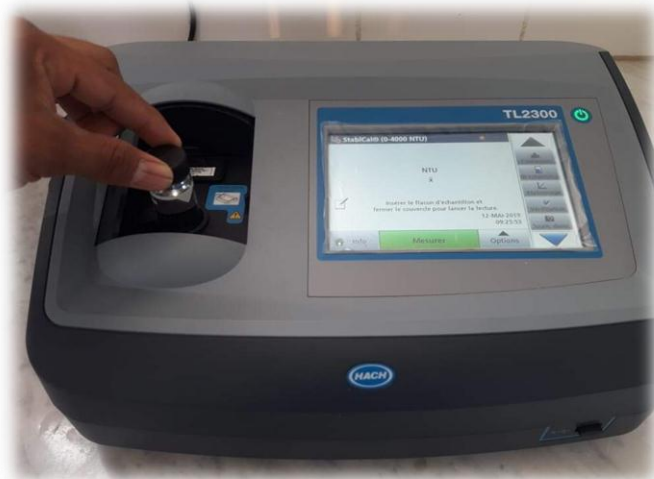
Figure 4: Turbidimètre (AMMARI Safa , 2019).
