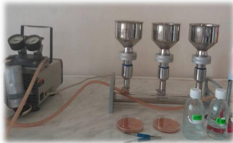
Figure 7: rampe de filtration sur membrane. ( AMMARI S, 2019).
