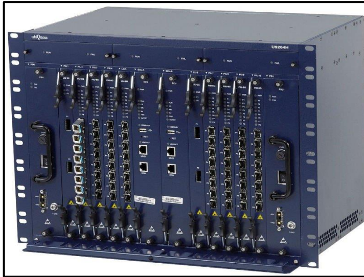
الصورة 1 : محطة الخط البصري OLT [42].
