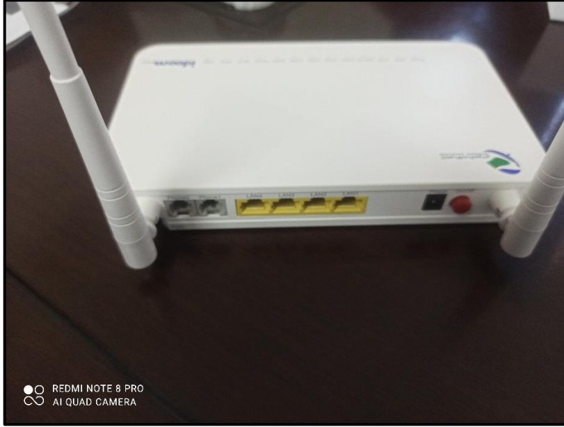
الصورة 5 : المحطة الطرفية الشبكة الضوئية ONT.
