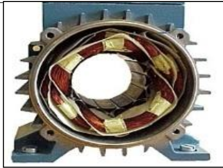
Figure I.7. Bobinage de la machine asynchrone.
