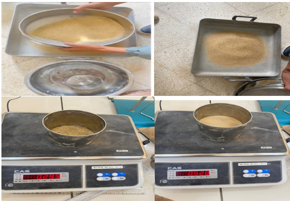
Figure III.6 : Explication du sable coincé dans les tamis
