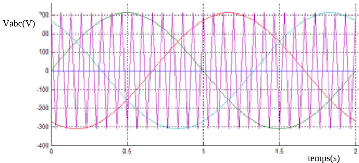
Figure IV.17 Les tensions simples V_{an} , V_{bn} et V_{cn} à la sortie d'un onduleur à trois niveaux à MLI sinusoïdale à une seule porteuse pour m=30 et r=0.9
