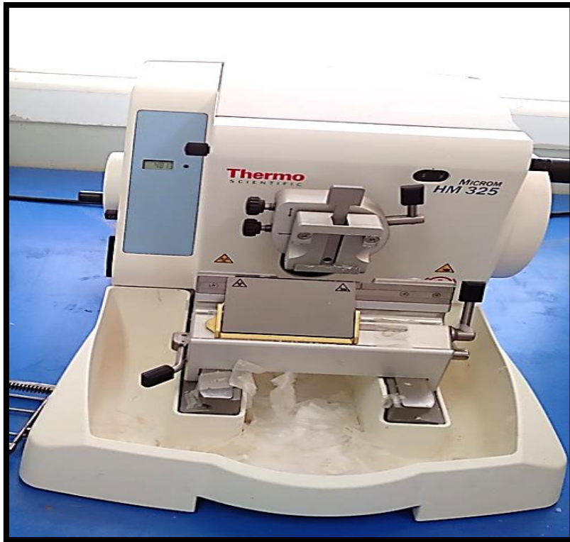
الوثيقة (15): جهاز المشراح (Thermo Scientific HM325 Microm)
