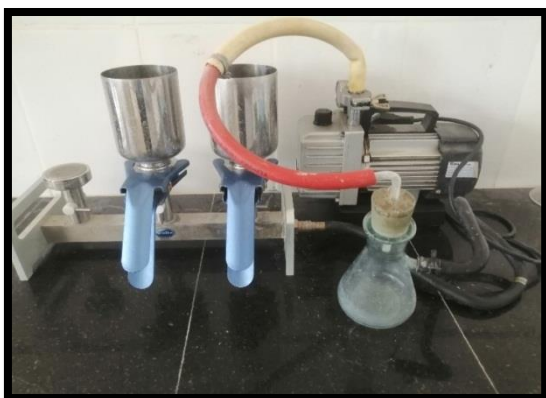
Photo 10 : Ensemble de filtration
