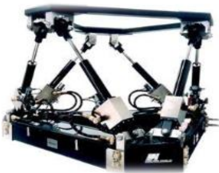
Figure 13 : Plate-forme de Gough
