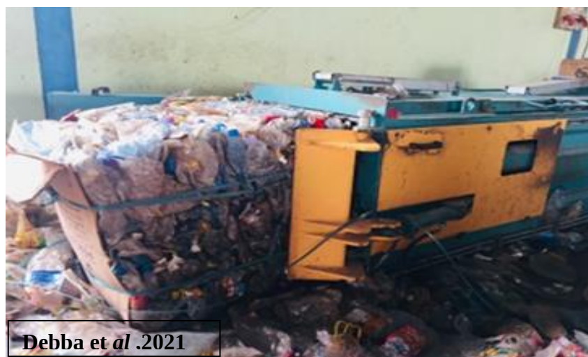
Figure N° 10 : Compression des matières
