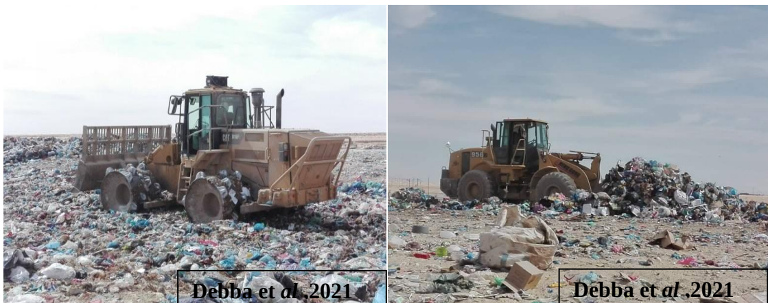
Figure N° 11: Répartition et compactage des déchets
