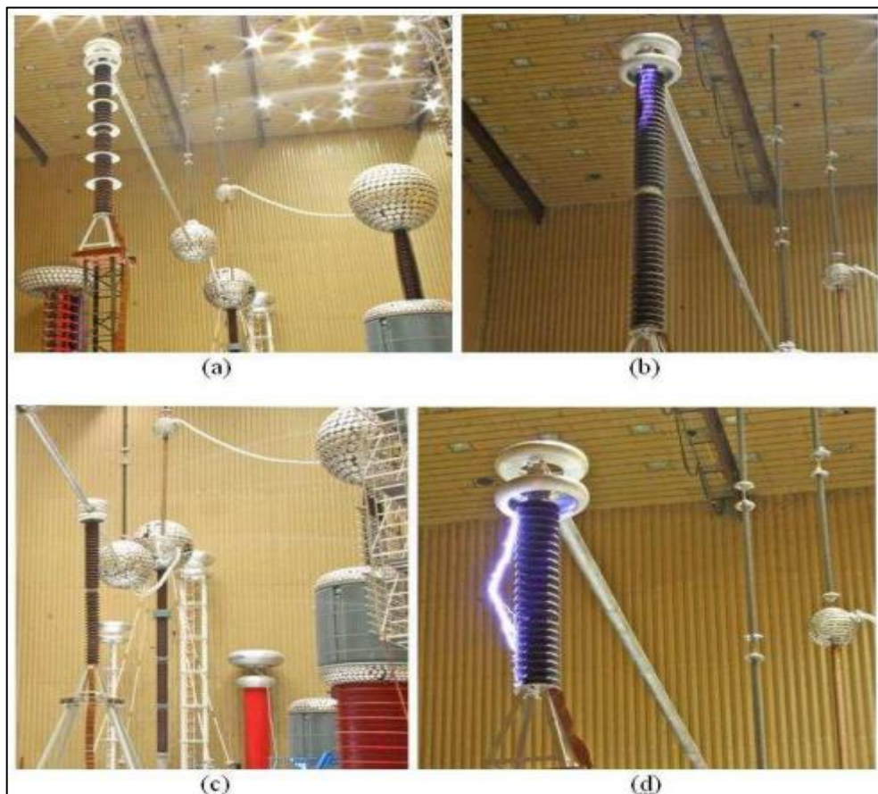
Figure II.12. Exemples d'agencements de circuits d'essai. Colonne isolante à l'extrémité d'un jeu de barres (a) avec et (b) sans BS ; colonne d'isolateur au milieu d'un jeu de barres (c) sans BS et section d'isolateur sans BS (d).
