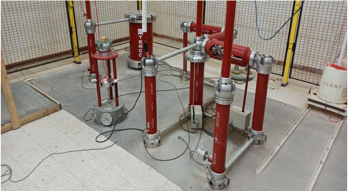
Figure III.4. Photo du circuit d'essai à fréquence industrielle.
