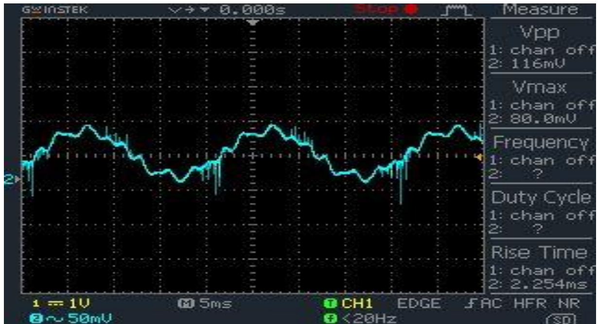
Figure III.19. Courbe graphique du courant de fuite dans le cas de la configuration A à 3 KV avec pollué.
