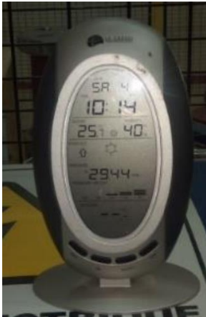
Figure III.7. Instrument de mesure pour les conditions atmosphériques (Humidité, température et pression).
