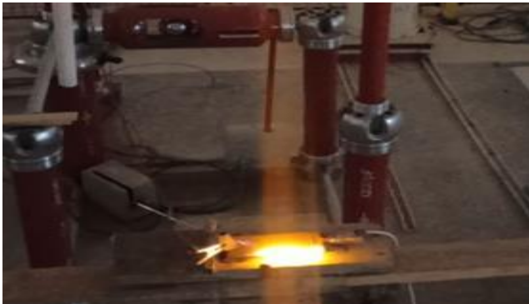
Figure III.8. Photo réel de contournement des déférentes configurations sèche, configuration A .
