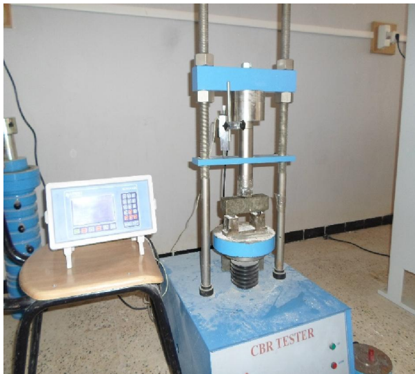
الصورة IV-4 جهاز قياس CBR تم تعديله لقياس مقاومة الانحناء للخرسانة
