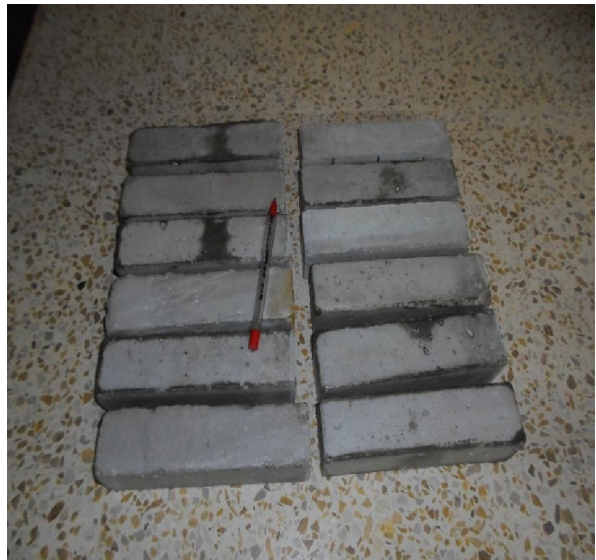
الصورة 6-IV عينات الخرسانة 160 \times 40 \times 40 مم المعدة لاجراء تجارب الضغط والانبعاث والامتصاص
