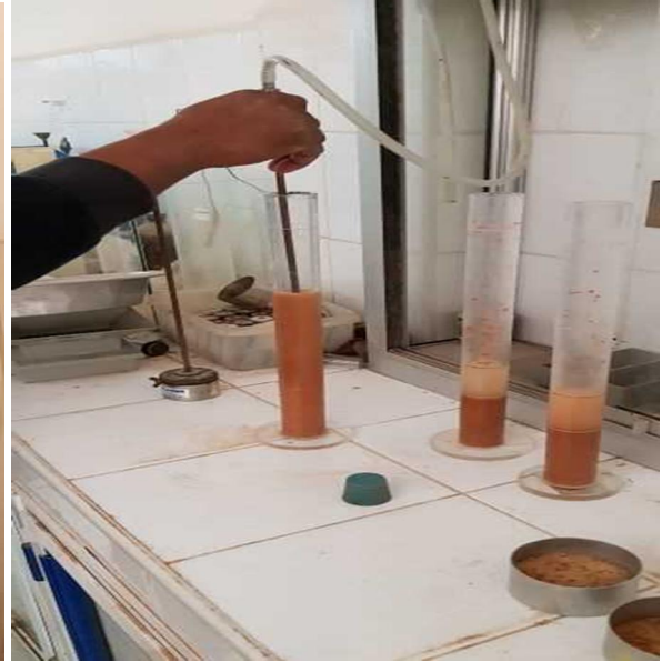
الصورة 7-IV أدوات قياس المكافئ الرملي
