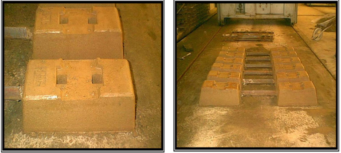
الصورة I-3 العوارض بخرسانة الرمل مصنع بني صاف
