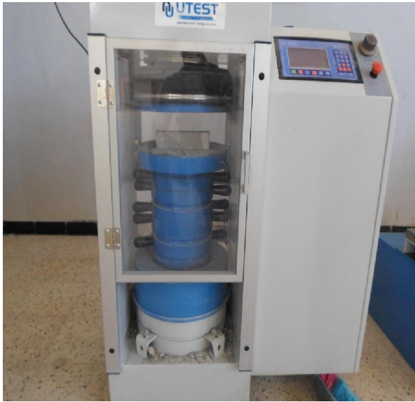
الصورة IV-2 آلة التحطيم الخاصة بتجربة الضغط
