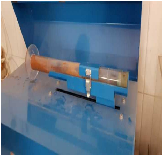
الصورة 8-IV جهاز الرج لقياس المكافئ الرملي
