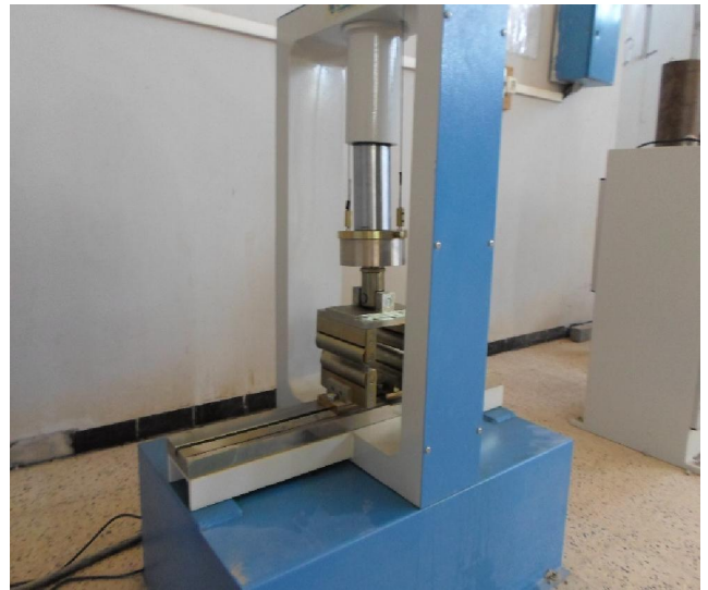
الصورة IV-3 جهاز قياس مقاومة الانحناء للخرسانة
