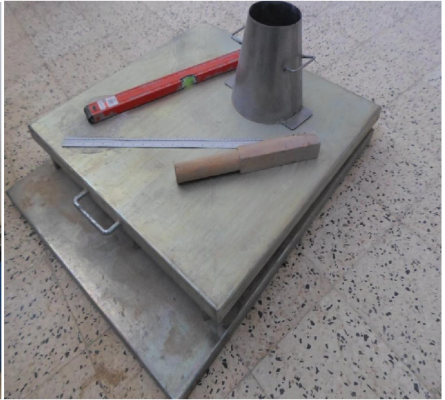
الصورة IV-1 قياس التشغيلية للخرسانة Table a chocs - المخروط - المدك - الميزان - والمسطرة
