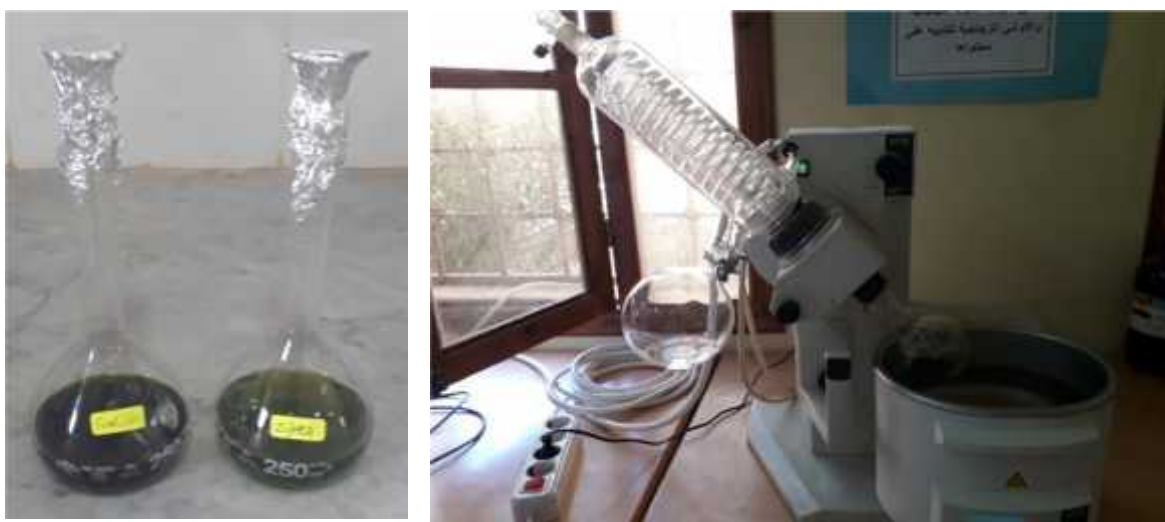
Figure III-3: concentration des extraits éthanoïque dans un évaporateur rotatif.
