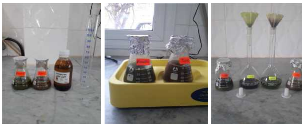
Figure III-2: macération et filtration des feuilles et des tiges de la plante Moltkia ciliata .
