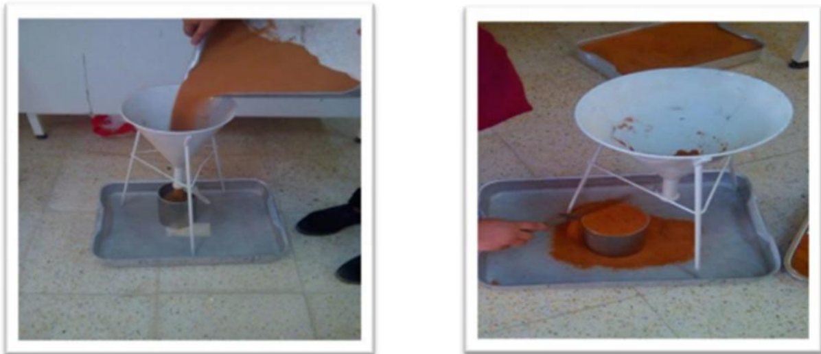
Figure II.7. Les matériaux de la masse volumique apparente
