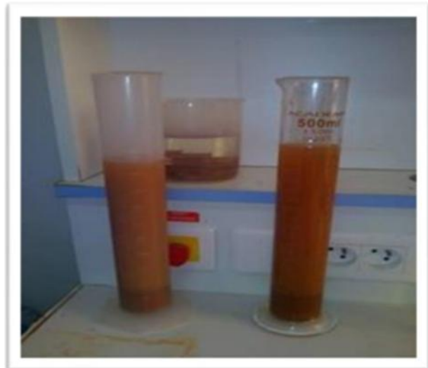
Figure II.8. Détermination de l'équivalent de sable.
