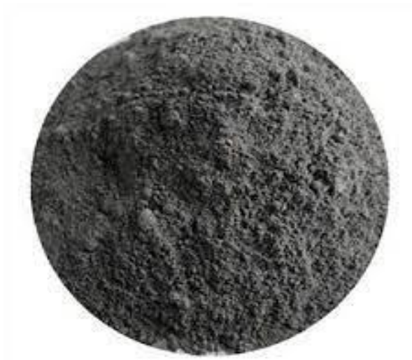
Figure III.2 : Fumé de silice (forme de poudre)
