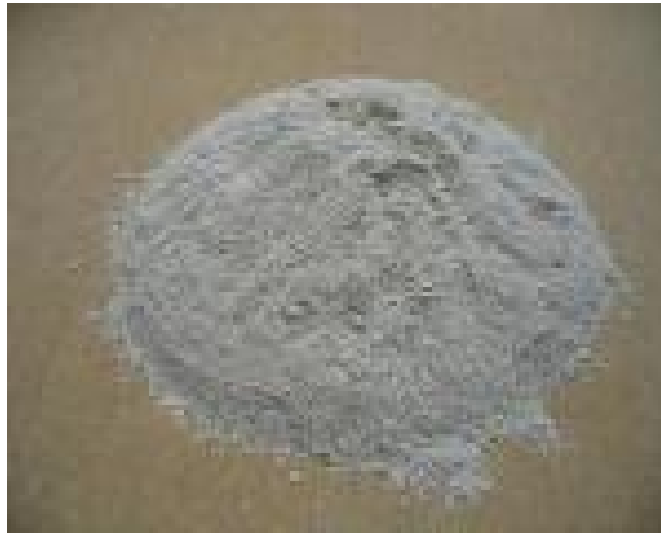
Figure III.1. Poudre de filler calcaire.
