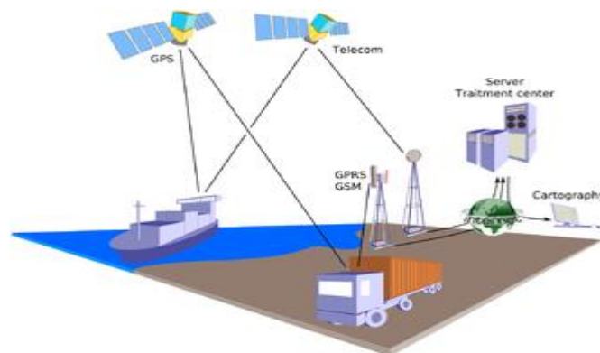
Figure 1.1 : Schéma des principes de géolocalisation par GPS [A4].
