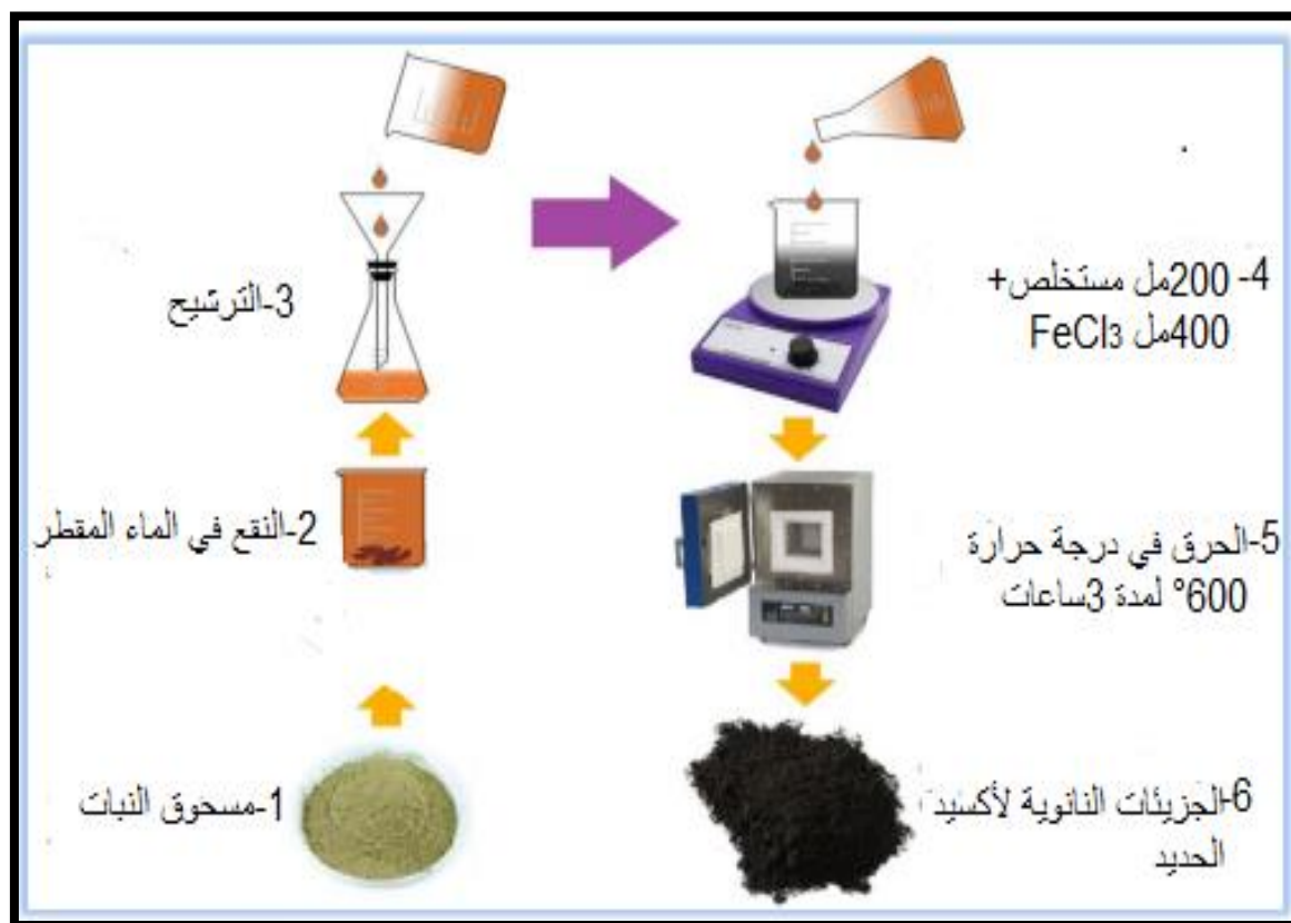
الشكل (IV-14): خطوات التصنيع الأخضر لجزيئات أكسيد الحديد النانوية.
