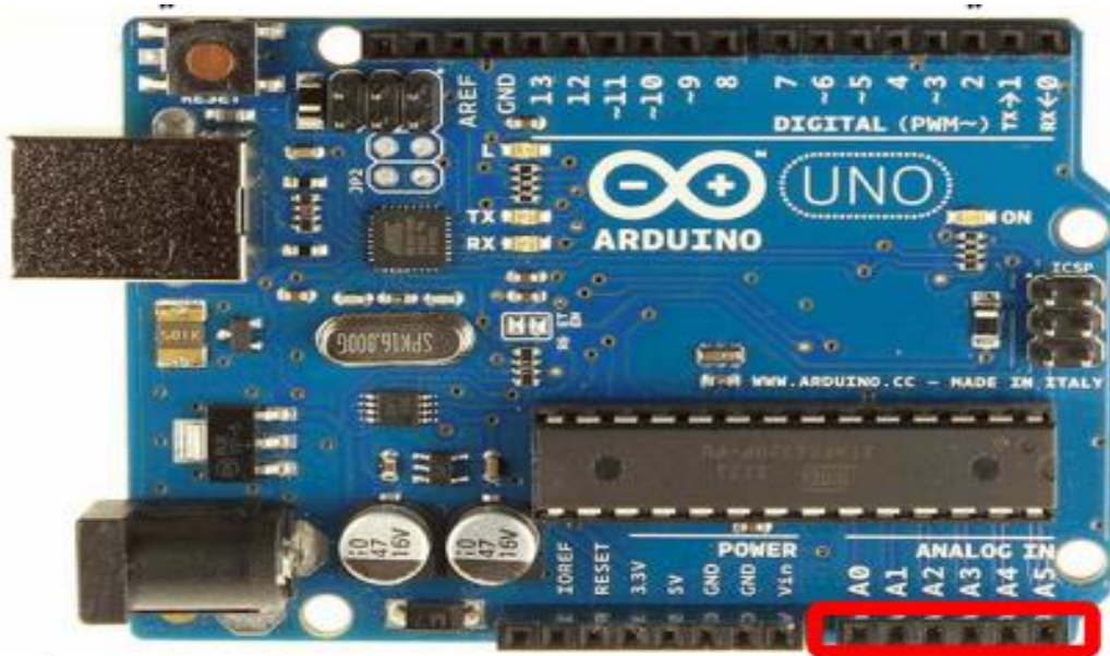
الملاحق الثالث: المداخل التشابهية الستة في لوحة الأردو بنو أونو.
