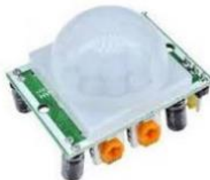
الشكل (05): صورة لحساس الحركة HC-SR501.
