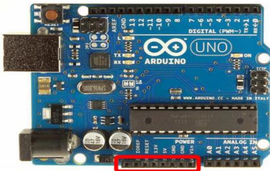
الملاحق الرابع: منافذ الاستطاعة من اليمين إلى اليسار Vin، GND، 5V، 3.3V. يضاف إليها، IOREF، RESET منفذ وفي الآخر منفذ غير مستخدم حالياً.
