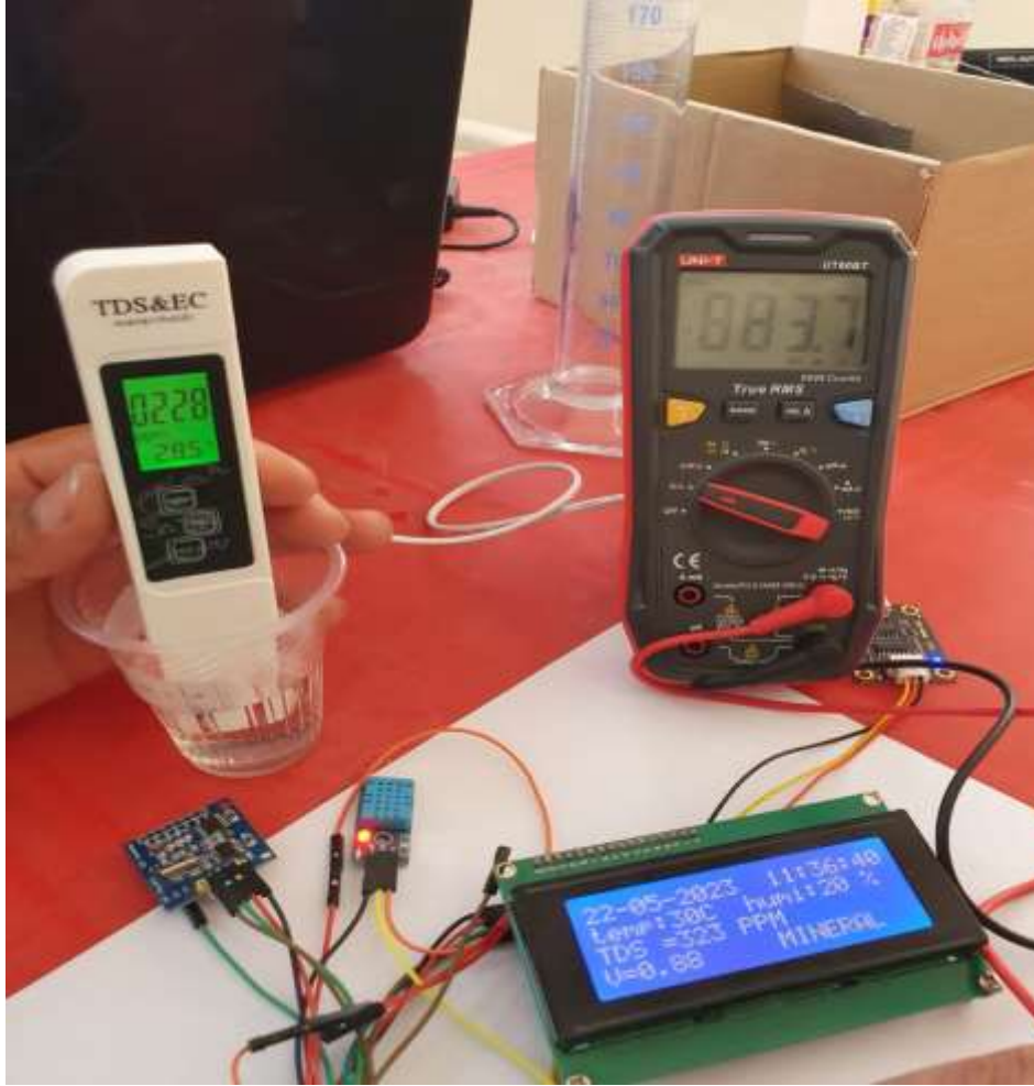
الشكل (29): توضح عملية معاينة نتيجة قياس النظام المقترح ومقارنتها مع جهاز قياس الـ TDS باستعمال ماء "معدني القنطرة".
