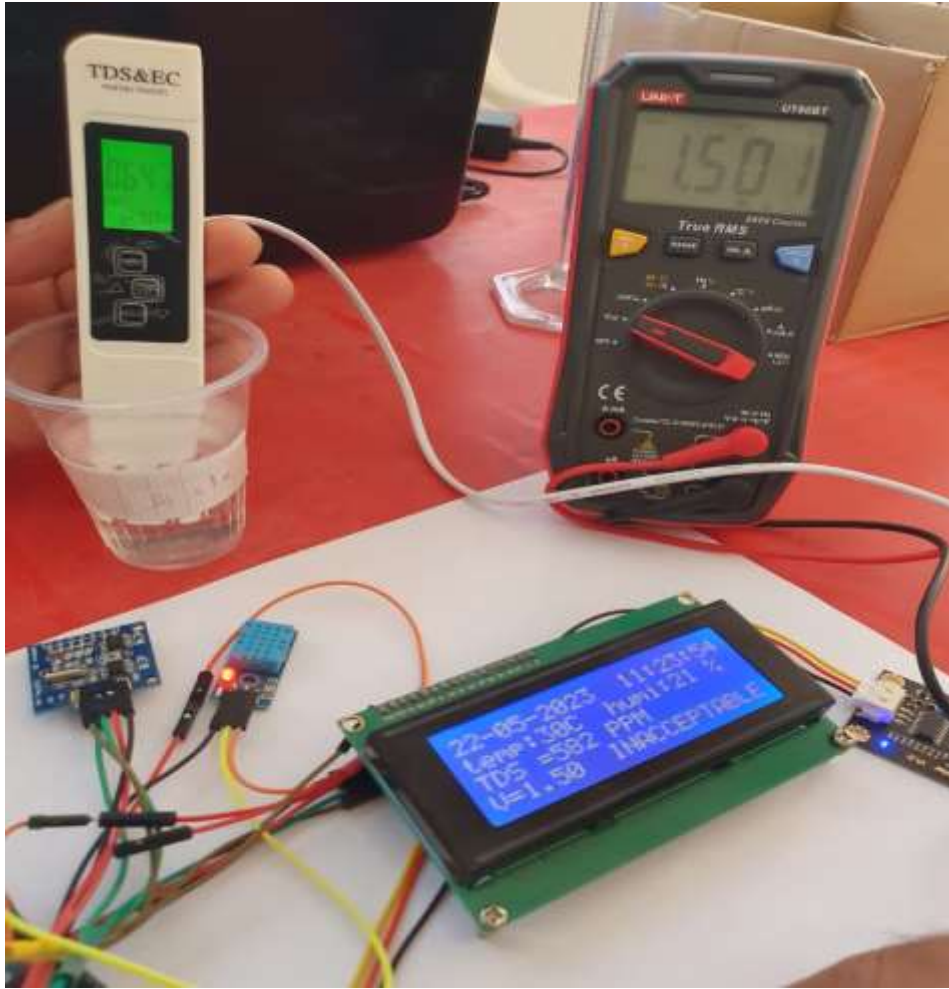
الشكل (26): توضح عملية معاينة نتيجة قياس النظام المقترح ومقارنتها مع جهاز قياس الـ TDS باستعمال ماء "بئرمنطقة المقرن".
