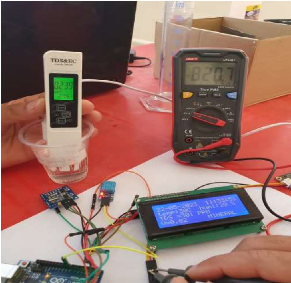
الشكل (30): توضح عملية معاينة نتيجة قياس النظام المقترح ومقارنتها مع جهاز قياس الـ TDS باستعمال ماء "معدني المنصورة".
