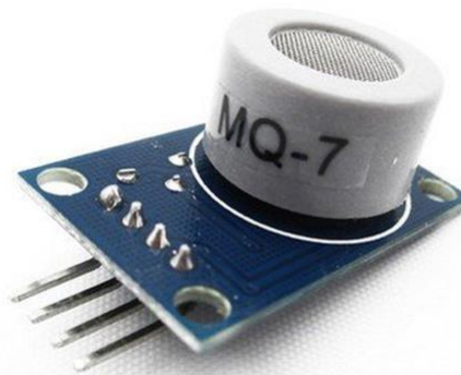
الشكل (07): صورة لحساس غاز أول أكسيد الكربون MQ7.
