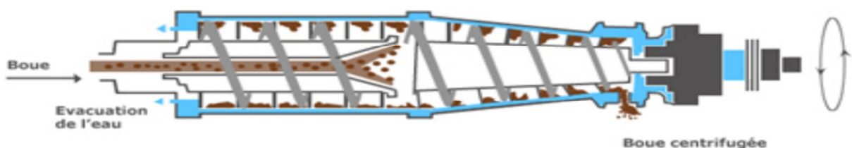
Figure III.1 : Schéma de principe d'une décanteuse centrifuge.
