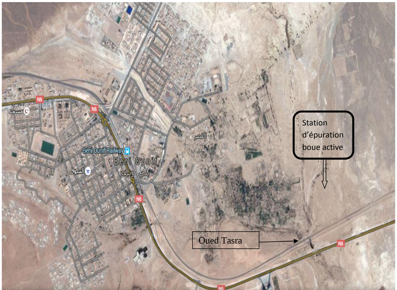
Figure VI. 2: Proposition du site de la station d'épuration.
