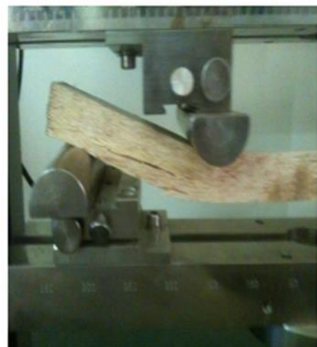
Figure 6: Epreuve délaminé après essai de flexion
