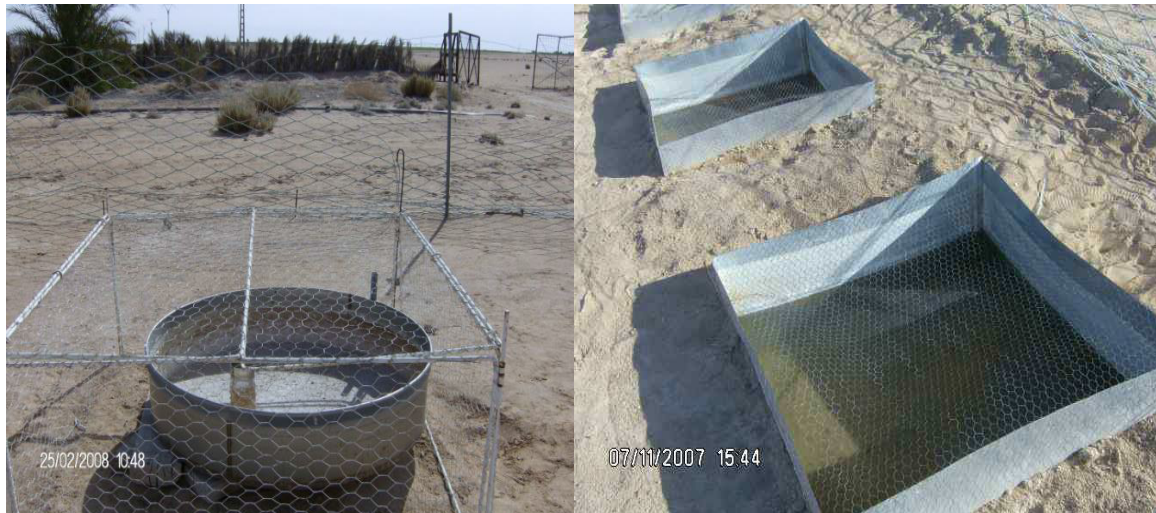
a) Bac d'évaporation Classe « A »
