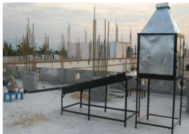
Figure I. 3 : La configuration expérimentale du séchoir solaire [29].
