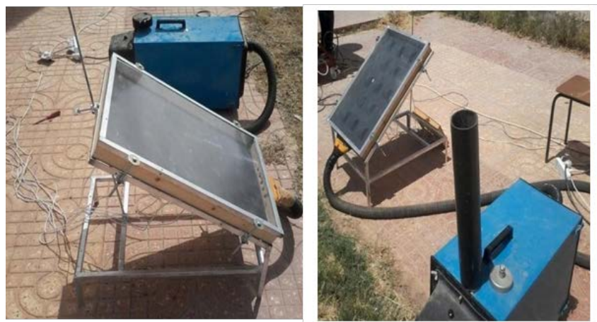
Figure II.16 : Montage expérimental (avec et sans ailerons) [21].
