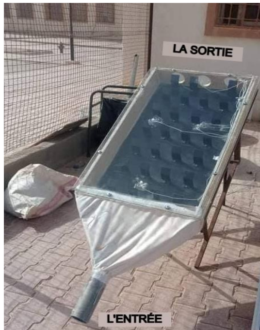
Figure I .25: Isolation thermique des longueurs d'entrée.
