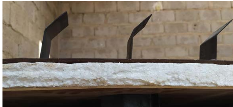
Figure I .24: Isolation thermique du capteur plan à air[30].
