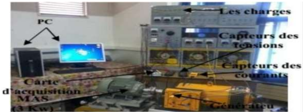
Fig. (III.1): Banc d'essai destiné au diagnostic du défauts de Barres.
