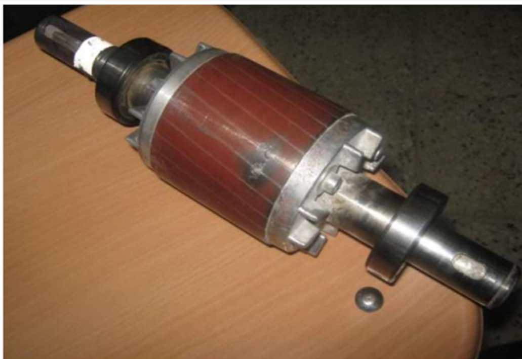
Fig. (II.3): le rotor du moteur avec 2 barres cassées.
