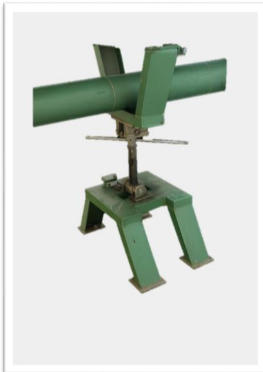
Figure III.3 : Bras de réglage de pente expérimentale.
