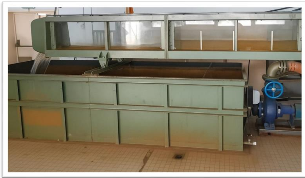
Figure III.4: Bassin d'accumulation dans le canal expérimental.
