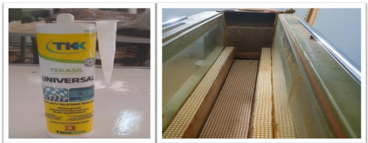
Figure III.11 :- 1. Adhésif Tekasil utilisé pour la fixation | 2. Tapis rugueux installé dans le canal expérimental.
