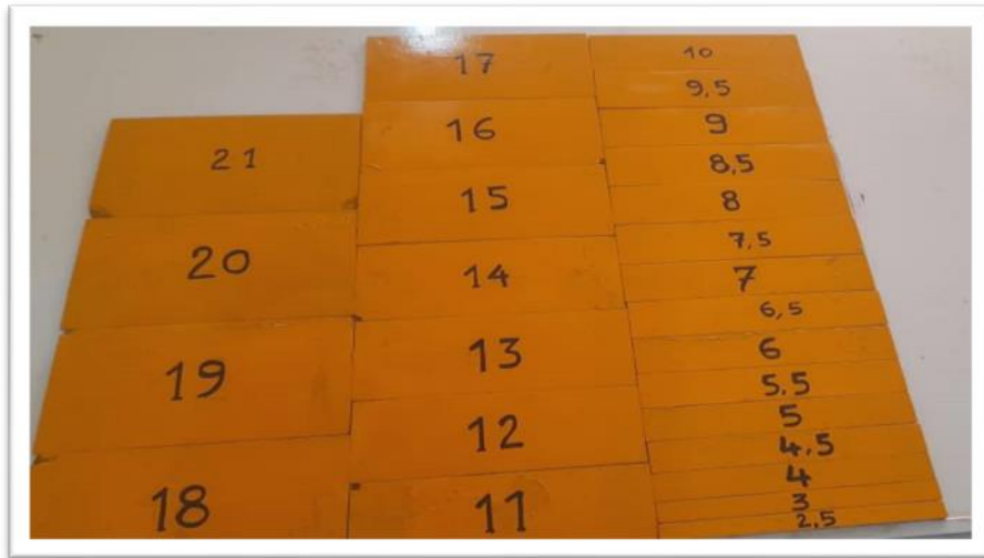
Figure III.8 : Parois minces de contrôle pour la formation du ressaut hydraulique.
