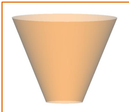
الشكل (III-8): التجويف البصري (القطر العلوي 13 مم ، القطر السفلي 4.5 مم الارتفاع 21 مم).
