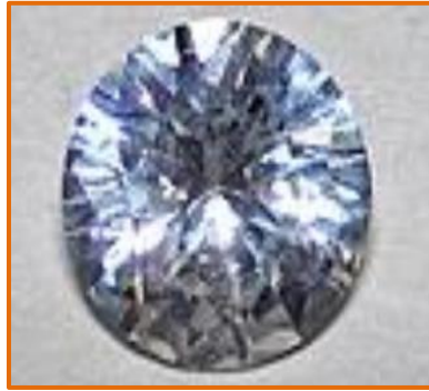
الشكل (II-6): عقيق الألمنيوم الإيتريوم (YAG, Y_3Al_5O_{12} ) [25].
