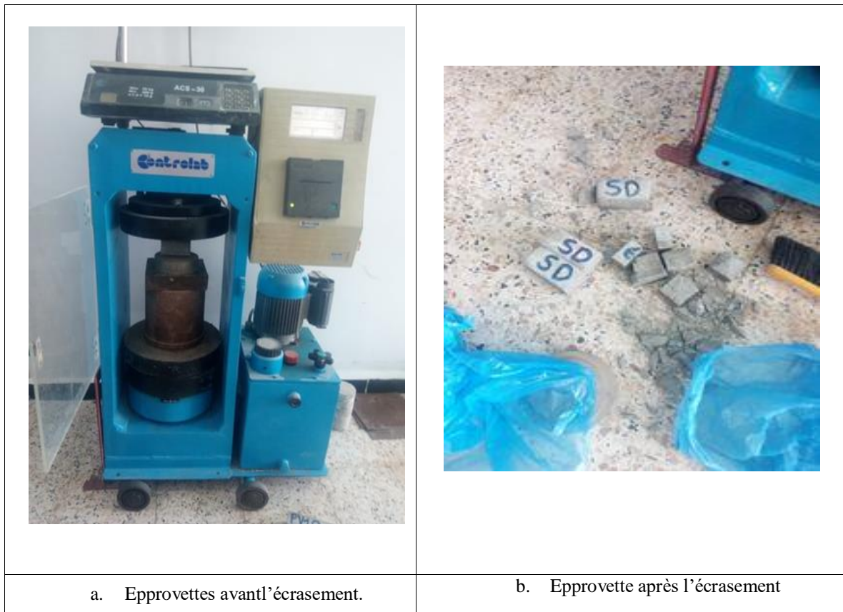
Figure 27II.13. Procédé de l'essai de rupture par compression.
