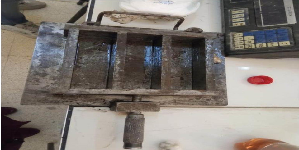
Figure n19 : Lubrifier les moules
