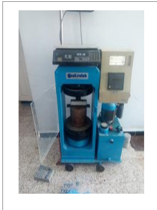
Figure 25 II. Procédure de l'essai de rupture par flexion.
