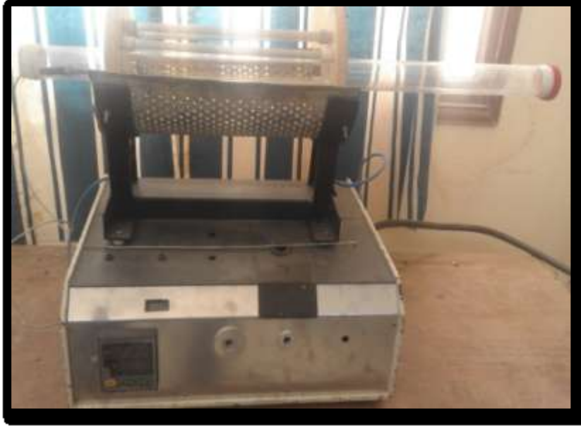
الشكل (IV - 5): رسم توضيحي يبين جهاز المعالجة الحرارية (صنع محلي).
