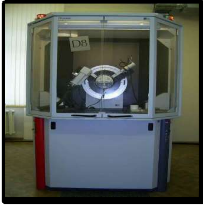
الشكل (III-3): جهاز انعراج الأشعة السينية (XRD) [4].
