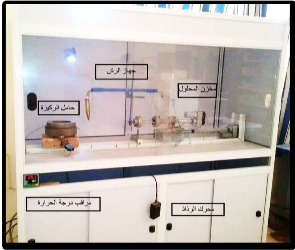
الشكل (1- IV): التركيب التجريبي لترسيب الأغشية الرقيقة " تقنية التحلل الكيميائي الحراري".
