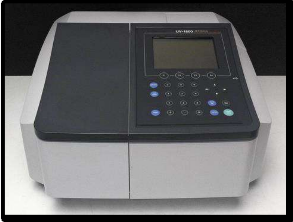
الشكل (III-6): جهاز التحليل الطيفي [11].
