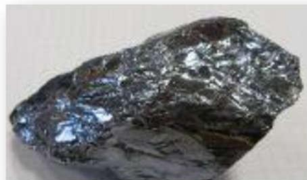
Figure 6: Silicium issu de la silice du sable
