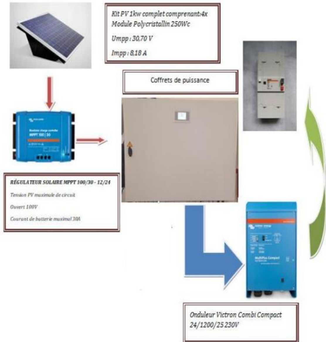
Figure IV.4: Schéma complet de l'installation de pompage PV[39].
