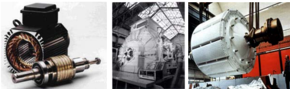
a : moteur industriel à aimants permanents qq kW (doc. aimants Philips).
