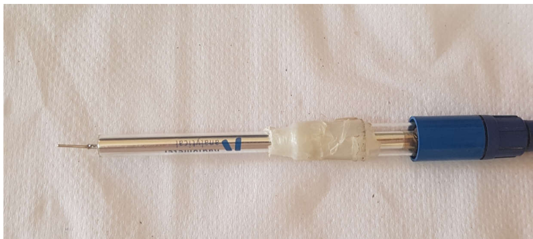
الشكل (II-5): قطب البلاتين المساعد (AE).
