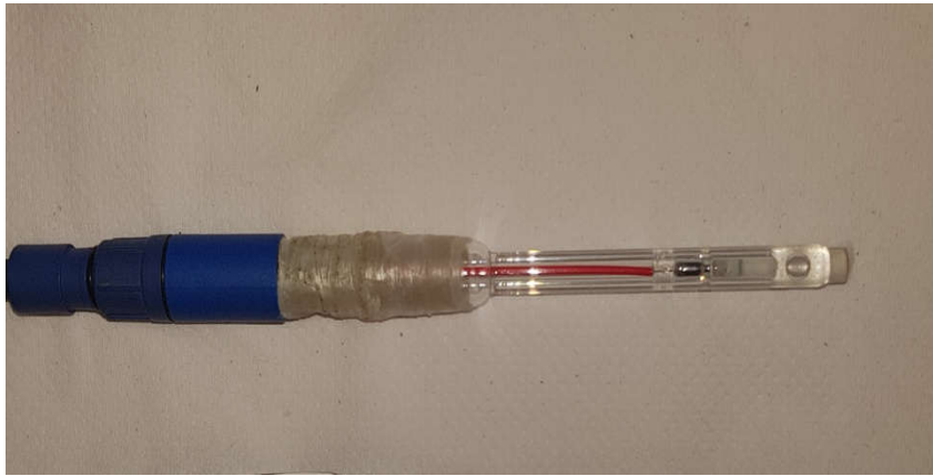
الشكل (II -4): قطب المرجع (ER).
