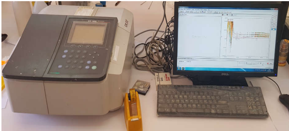
الشكل (II-10): يوضح جهاز الأشعة فوق البنفسجية Shimadzu 1800.
