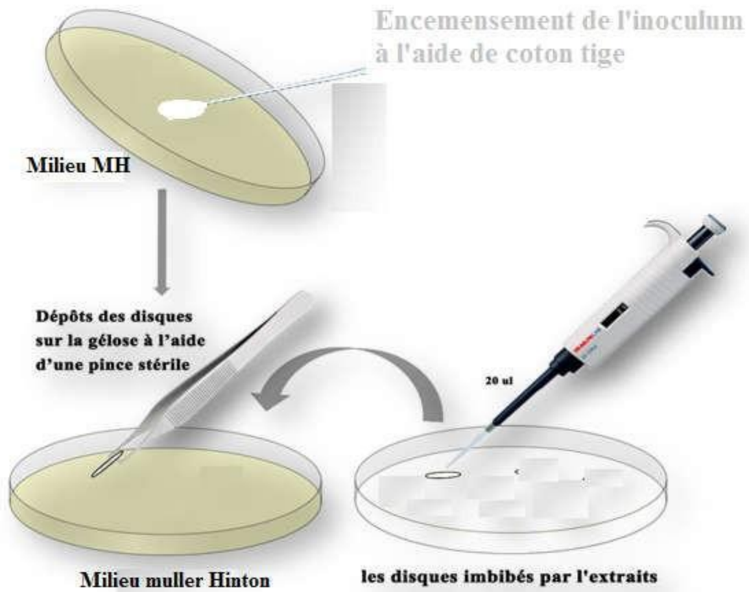
Figure 23: Principe de l'évaluation de l'activité antibactérienne par la méthode de diffusion sur disques.
