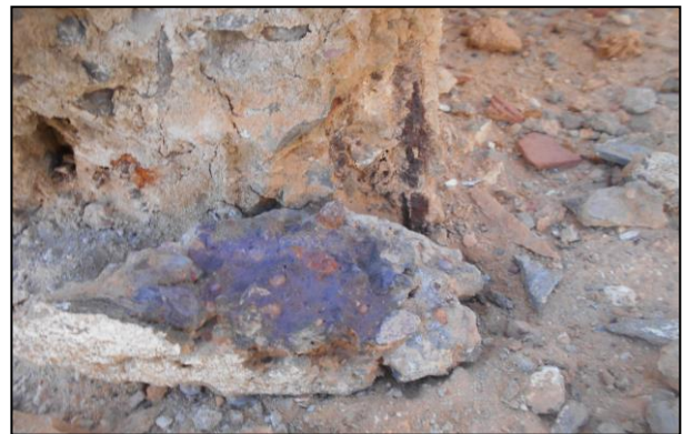
Figures III.13 : Front de carbonatation déterminée par pulvérisation d'une solution de Phénolphtaléine sur une surface fraîche.
