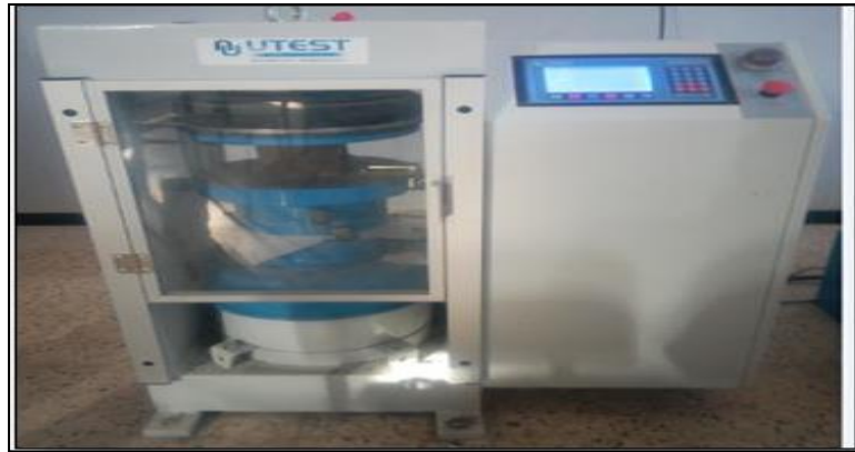
Figure II .11 : Essais de la compression des carottes
