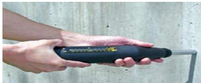
Figure II .4 : Scléromètre (NF EN 10250-2)
