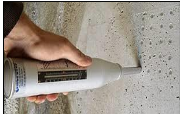
Figures III.17: Essais du scléromètre
