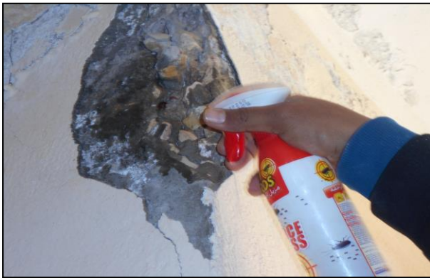
Figures III.13 : Front de carbonatation déterminée par pulvérisation d'une solution de Phénolphtaléine sur une surface fraîche.
