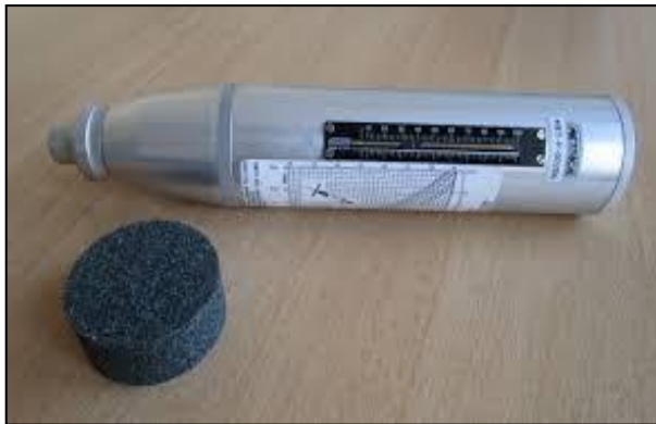
Figures III.17: Essais du scléromètre
