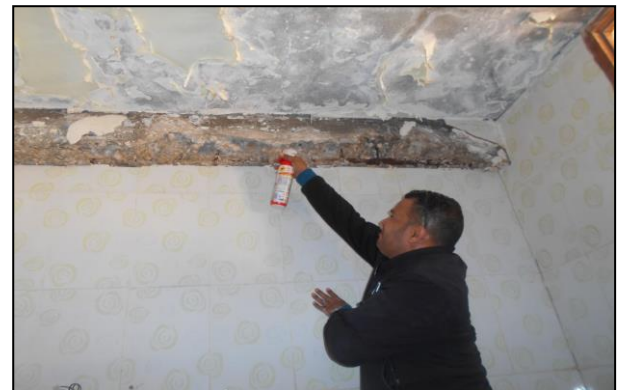
Figures III.14 : Migration de chlorure, précipitation visible blanc de chlorure d'argent
