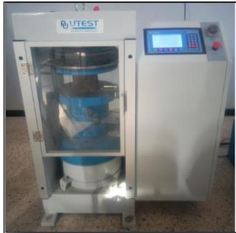
Figures III.20: Essais de la compression des carottes
