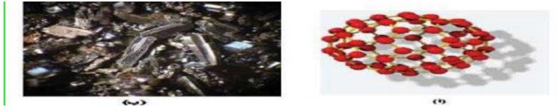
Figure 10: Fullerène C60 sous forme moléculaire. Fullerène C60 sous forme cristalline[16].
