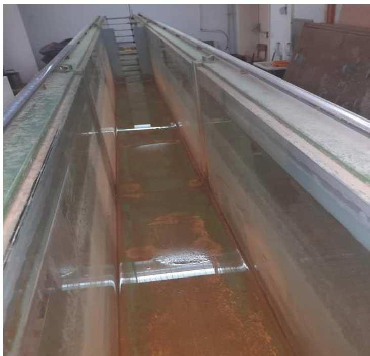
Photo I.6 : Déversoir rectangulaire inséré dans le canal expérimental.
