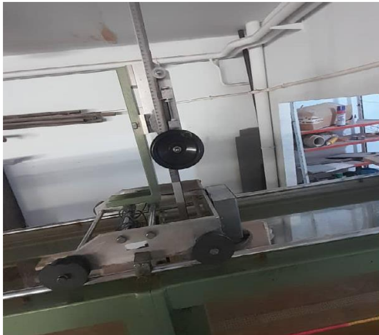
Photo I.8 : Le limnimètre utilisé pour mesurer la hauteur d'eau dans le canal expérimental.
