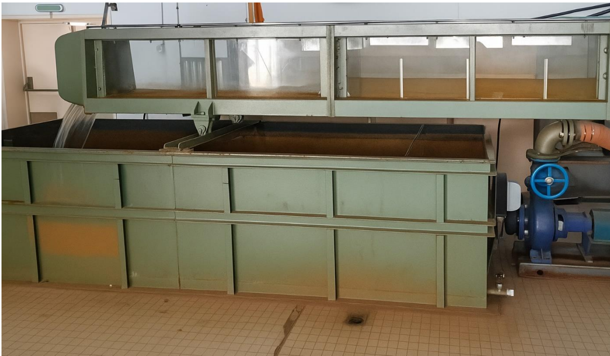
Photo I.4 : Bassin d'accumulation dans le canal expérimental.
