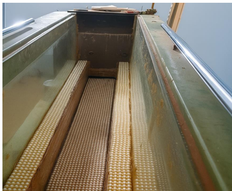
Photo I.12 : - 1. Adhésif Tekasil utilisé pour la fixation | 2. Tapis rugueux installé dans le canal expérimental.
