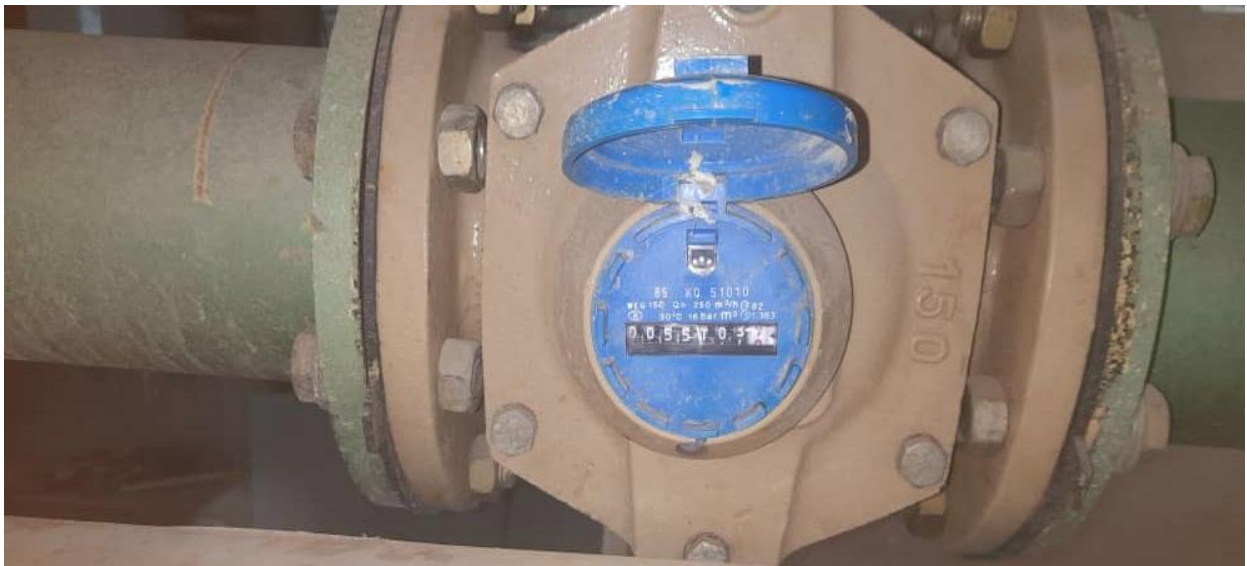
Photo I.5 : Débitmètre d'eau dans le canal expérimental.
