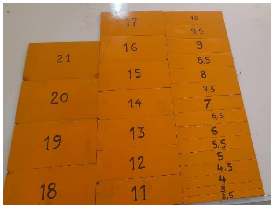
Photo I.9 : Parois minces de contrôle pour la formation du ressaut hydraulique.
