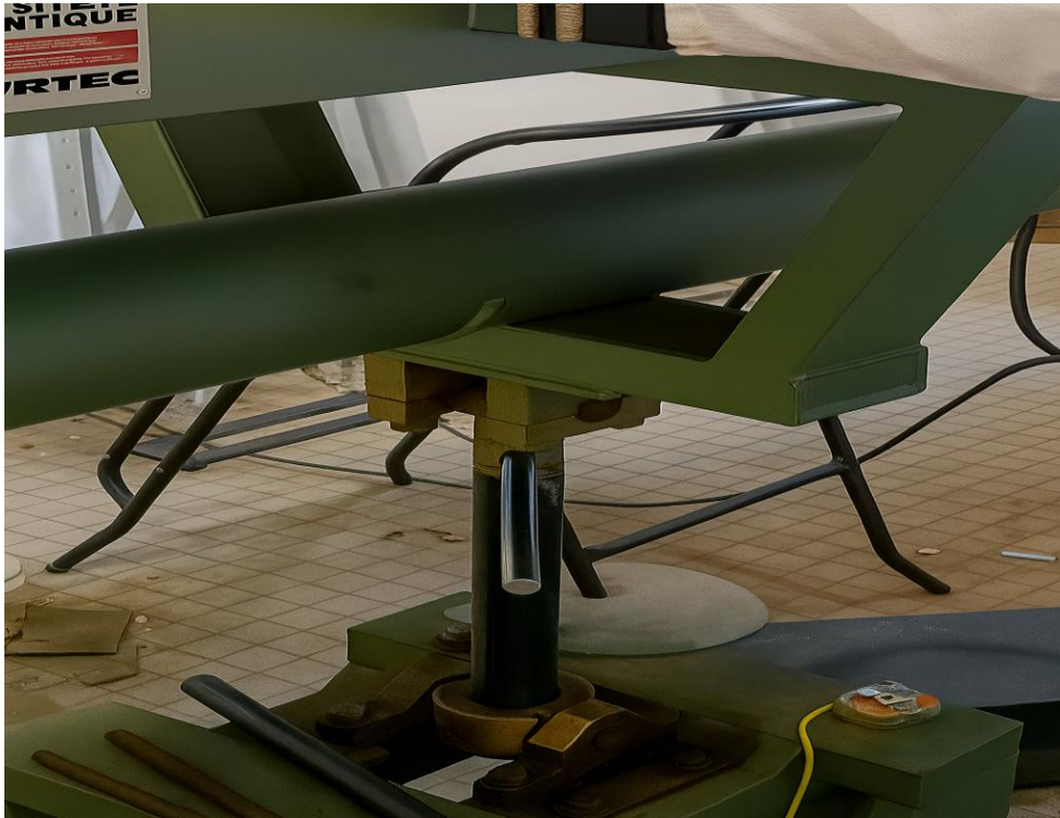
Photo I.3 : Bras de réglage de pente expérimentale.
