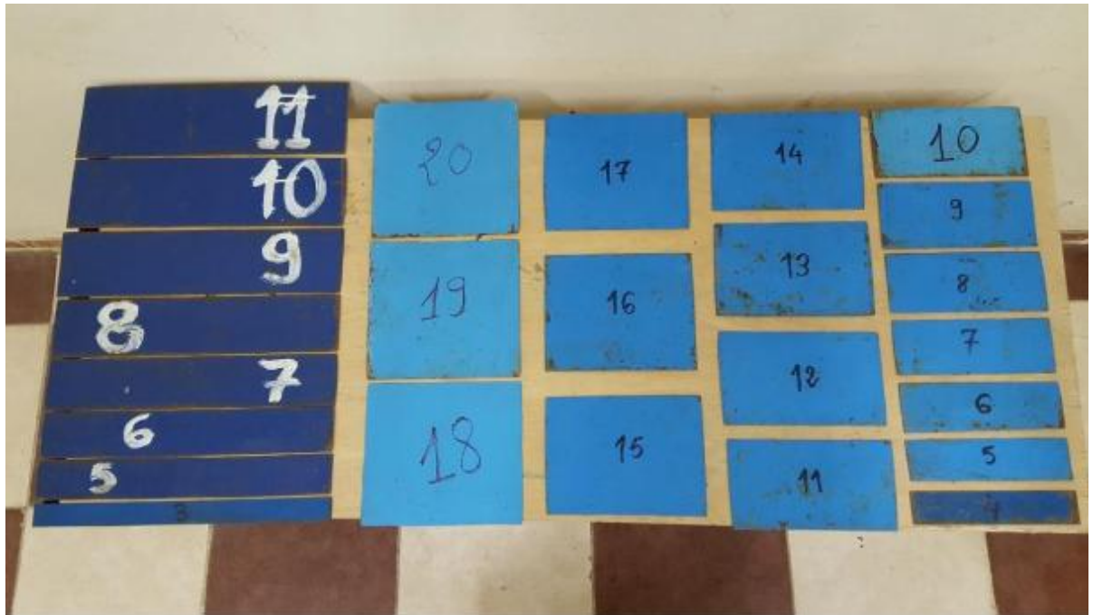
Photo III.11 : Photographie des seuils minces testés.
