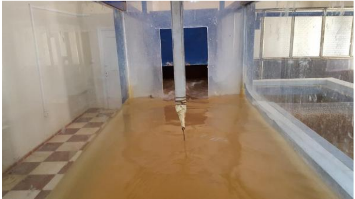
Photo III.10 : Photographie du déversoir rectangulaire sans hauteur de pelle avec contraction latérale ayant servi à la mesure du débit.
