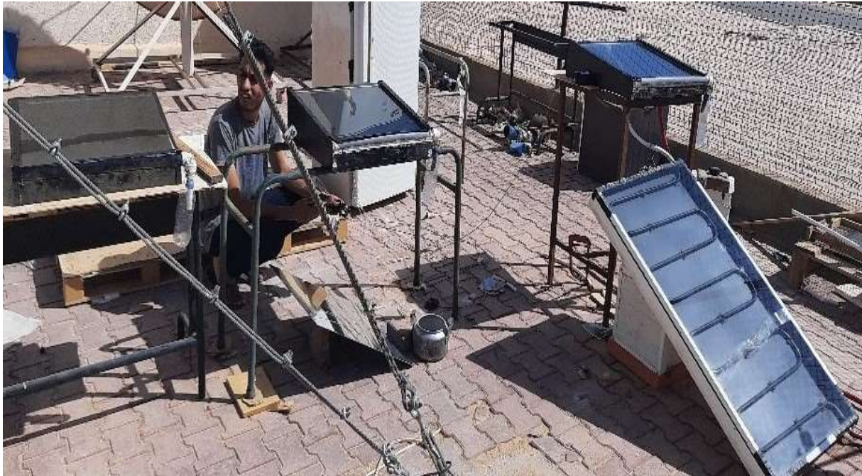
الشكل V (48): مقارنة بين مقطر مدعم بزجاجة ومقطر مدعم بسخان شمسي في وضع عمودي مائل
