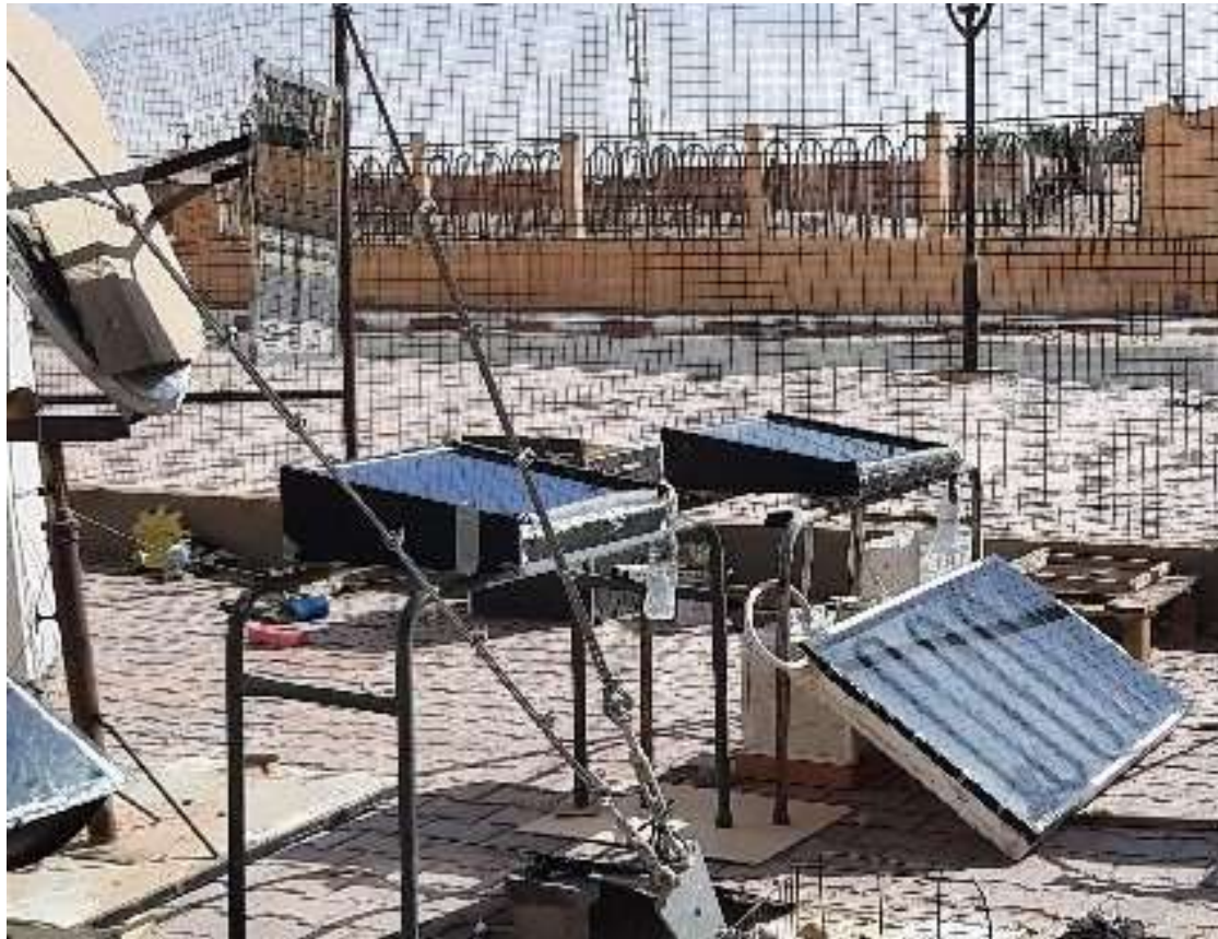
الشكل V (28): المقارنة بين مقطرين شمسين بسيطين الأول مقطر عادي بزود بعاكسين سفلي و علوي و الثاني مقطر مزود بسخان ماء شمسي في وضع أفقي مائل.
