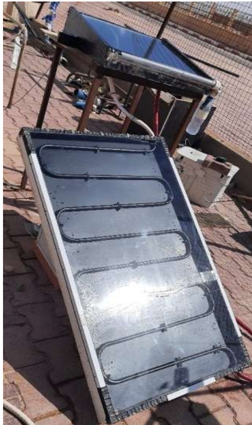
الشكل V (9): مقطر مزود بسخان ماء شمسي في وضع عمودي مائل.
