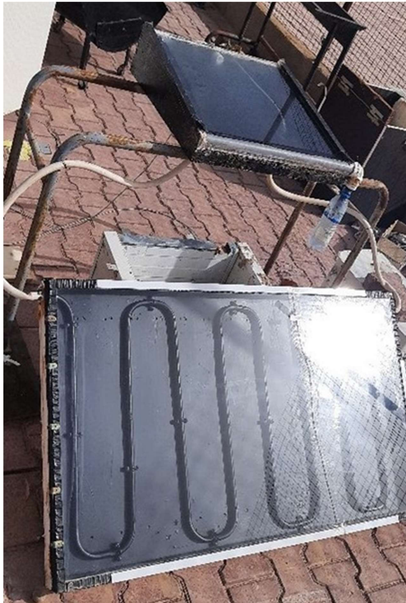
الشكل V (29): مقطر مزود بسخان ماء شمسي في وضع أفقي مائل.
