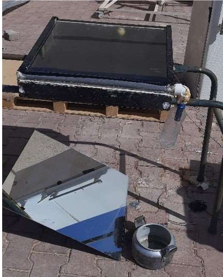
الشكل V (47): مقطر مدعم بزجاجة
