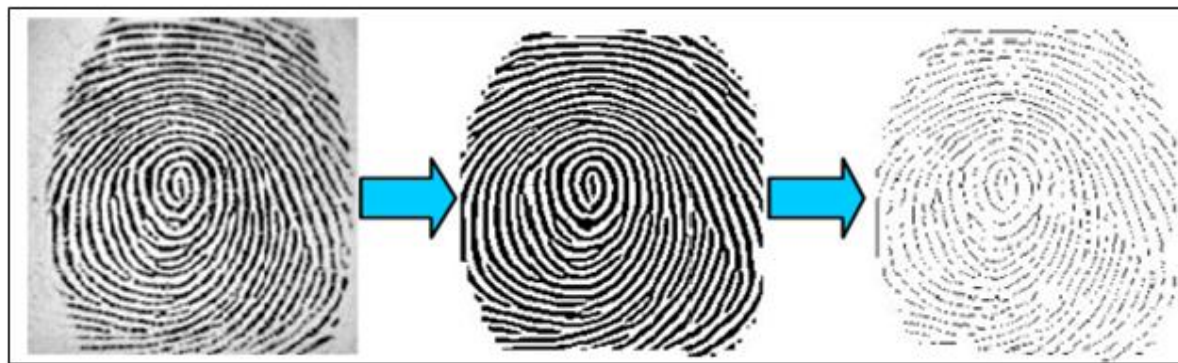
Figure I - 3 : Prétraitement des images d'empreintes digitales (extraction des minuties)
