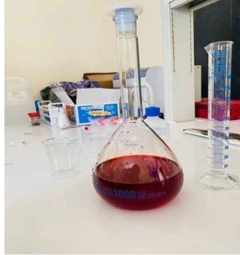
الشكل (III-5): محلول قياسي لأحمر الكونغو بتركيز 1000 ppm.
